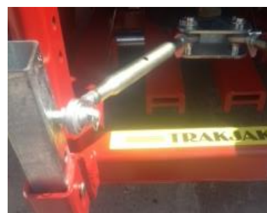
De twee verbindingstukken (die in lengte verstelbaar zijn) verbinden de trekhaak met de best passende opening in de steunpoten aan de achterkant.
