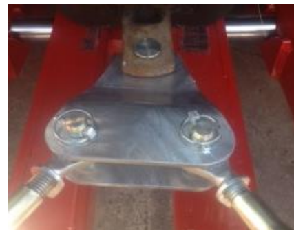
Het koppelstuk voor de trekhaak (Onderdeel A) wordt bevestigd aan de trekhaak van de tractor.
